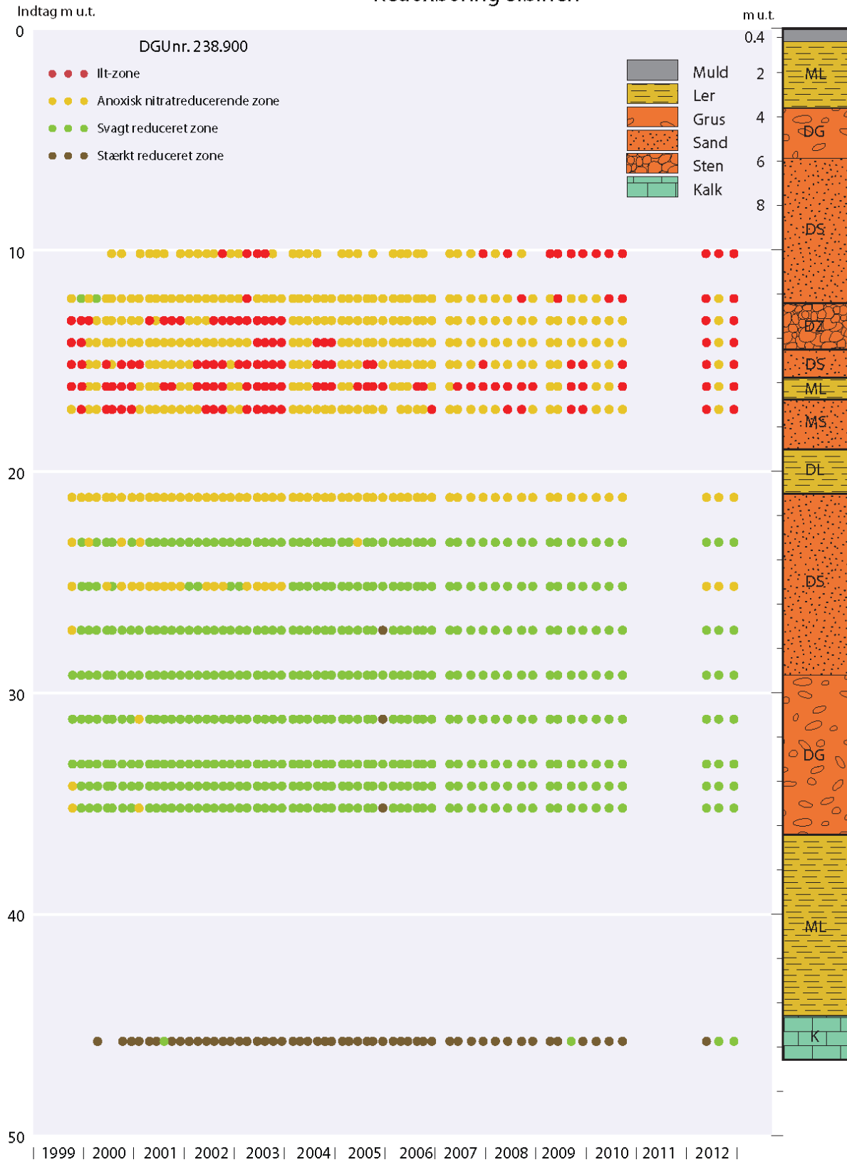
Figur 19. Redoxzoner 10 - 46 m.u.t. for redoxboring DGU nr. 238.900, Sibirien på Falster, 2000-2012. Grundvandspejl i ca. 8-9 m u.t. Den geologiske lagserie er vist længst til højre.
