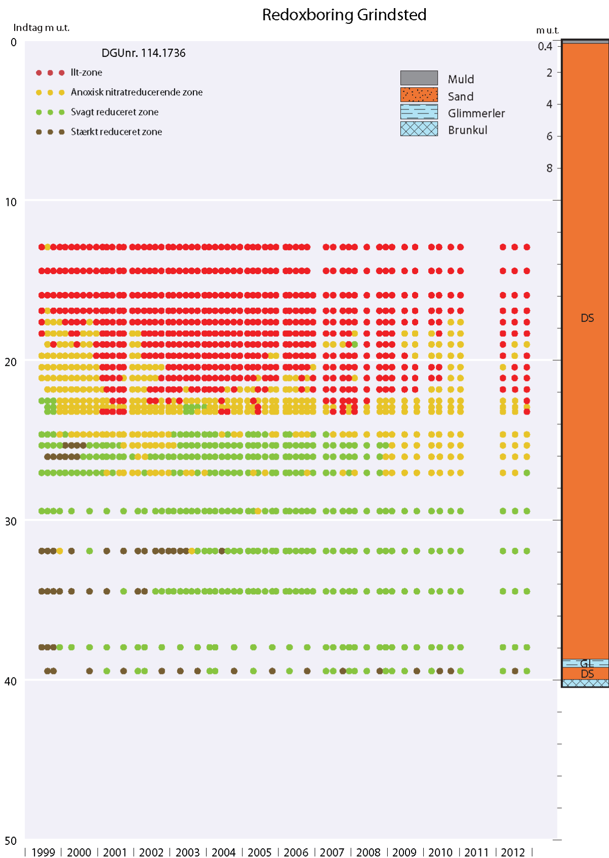
Figur 18. Redoxzoner 23- 40 m u.t. for redoxboring DGU nr. 114.1736, Grindsted 2000-2012. Grundvandsspejl i ca. 6 m u.t. Den geologiske lagserie er vist på figuren længst til højre.
