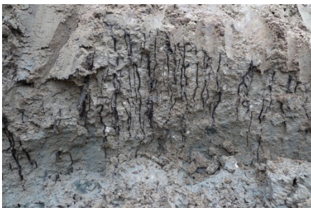
I udgravningen hvorfra der "bores" ses gamle planterødder helt til bunden dvs. ca. 2 m u.t.
