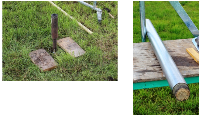
Figur 2: Billedet til venstre viser borehullet, mens det højre billede viser borerøret med sedimentkernen i et 50 mm rør.
