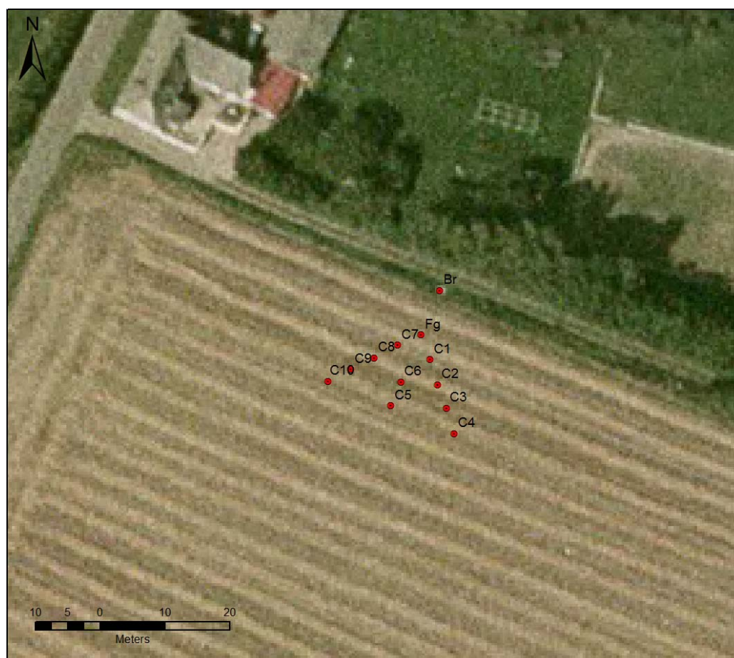
Figur 3-3. Placering af de nyinstallerede 10 sugeceller (C1-C10), forgreningen af beskyttelsesrør (Fg) og opsamlingsbrønd (Br) jf. Tabel 3-2
