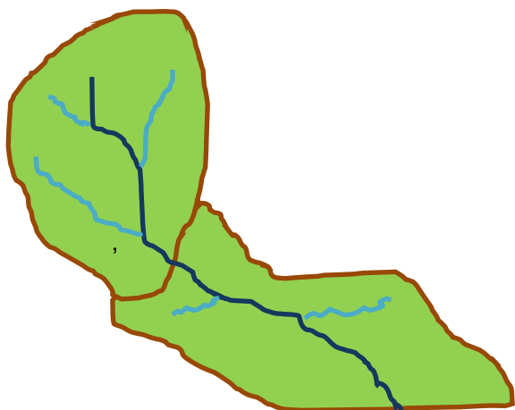
Figur 10. Skitse, der repræsenterer hovedvandløb, der binder vandafstrømningen mellem 2 deloplande (ID15) sammen (mørkeblå), og små vandløb (interne vandløb (IV)), der alene udleder vand inden for et delopland (lyseblå).
