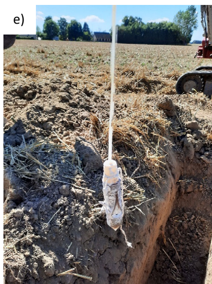
Figur 1. a) samlebrønd og pejleboring, b) samlebrønd, c) rende, beskyttelsesrør og prøvetagnings-slanget, d) sugecelleslanget og beskyttelsesrør, e) sugecelle, f) mark efter sløjfning af installationer
