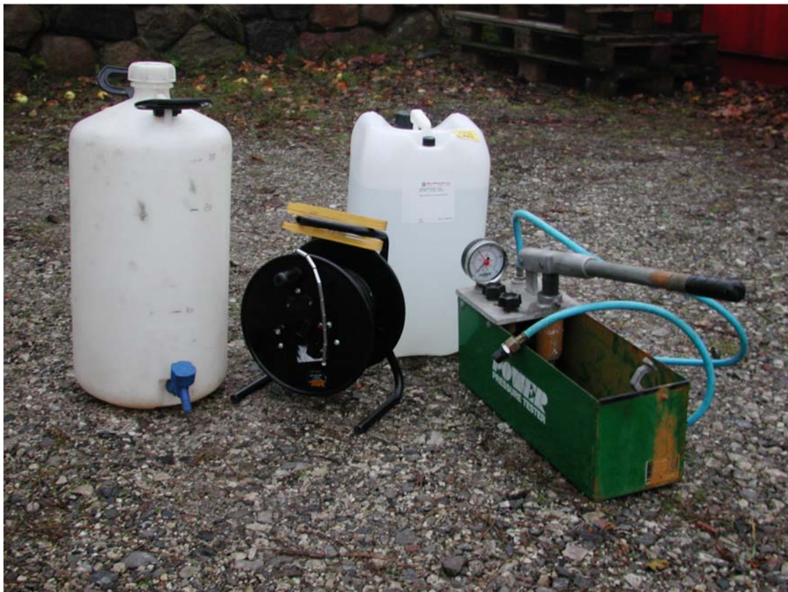
Fig. C: Udstyr til trykprøvning med vand
