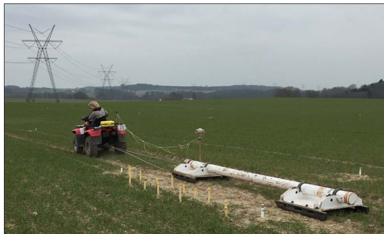
Figur 1: DUALEM421S sensor monteret på slæde og trukket af en ATV. (Foto: Jesper Pedersen).
