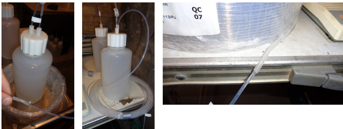
Figur 2-2. Sugecelleslangen er koblet sammen med den testede slangelængde ved hjælp af et ca. 5 cm langt stykke silikoneslange
