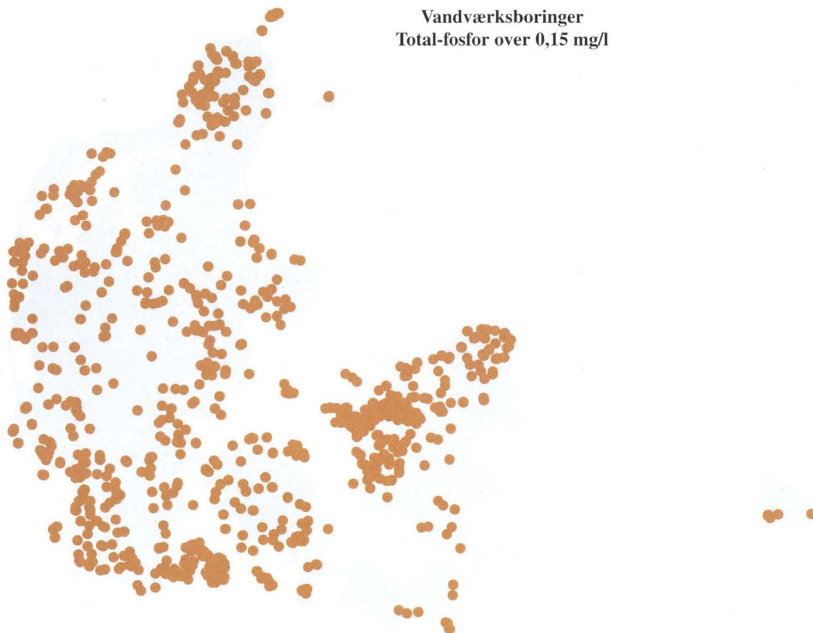
Figur 2.11 Fosfor i vandværksboringer. Medianværdier for perioden 1990-1999 over den højst tilladelige værdi for drikkevand på 0.15 mg/l fosfor.
