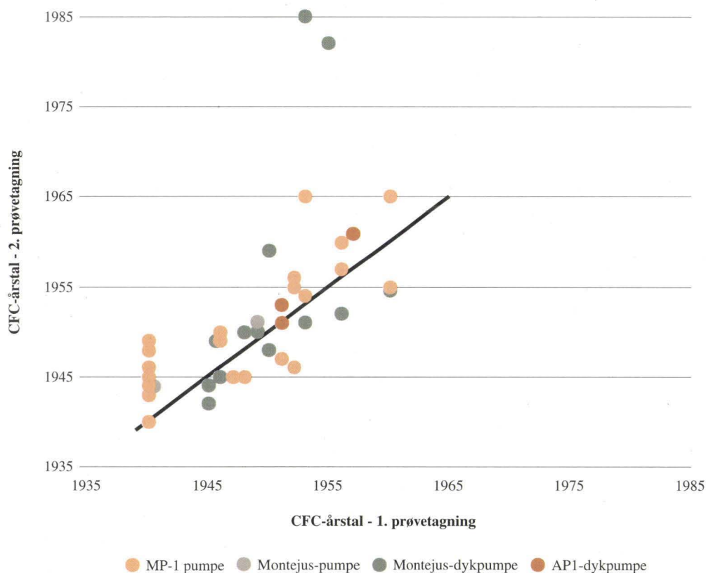
Figur 8.3. Sammenligning af CFC-resultaterne af 1. og 2. prøvetagning. Tidsrummet mellem de to prøvetagninger var 1-1½ år.
