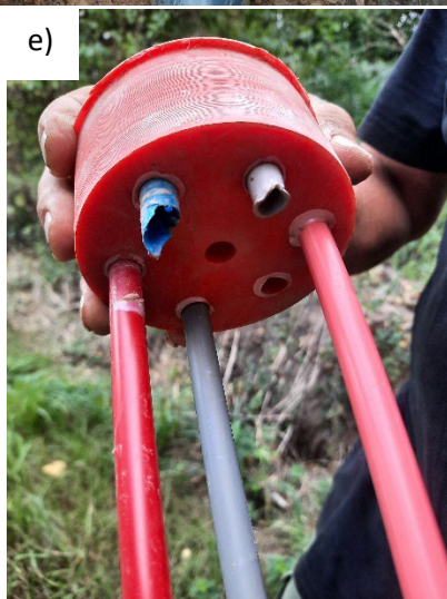
Figur 1. a) prøveudtagningsbrønd, cemenrør, b) beskyttelsesrør i bund af rende, c) defekte prøvetagnings-slangers, d) prøvetagnings-slangers repareret, e) gamle porøse pvc-rør i prøvetagningsbrønd, f) nye PE-slangers i prøvetagningsbrønd
