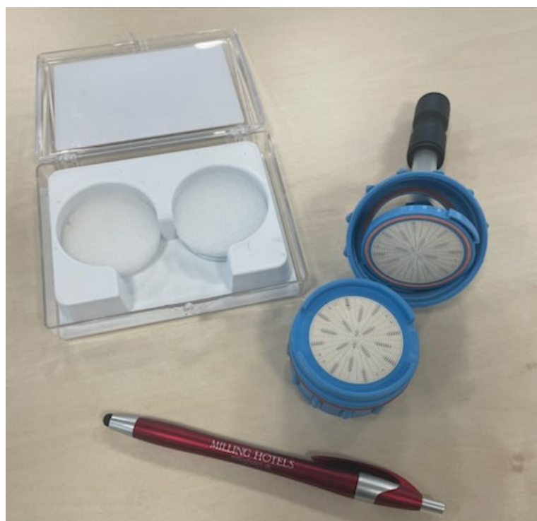
Figur 2. Filterholder til løse filtre fx af polykarbonat, som i æsken, anvendt til denne undersøgelse.
