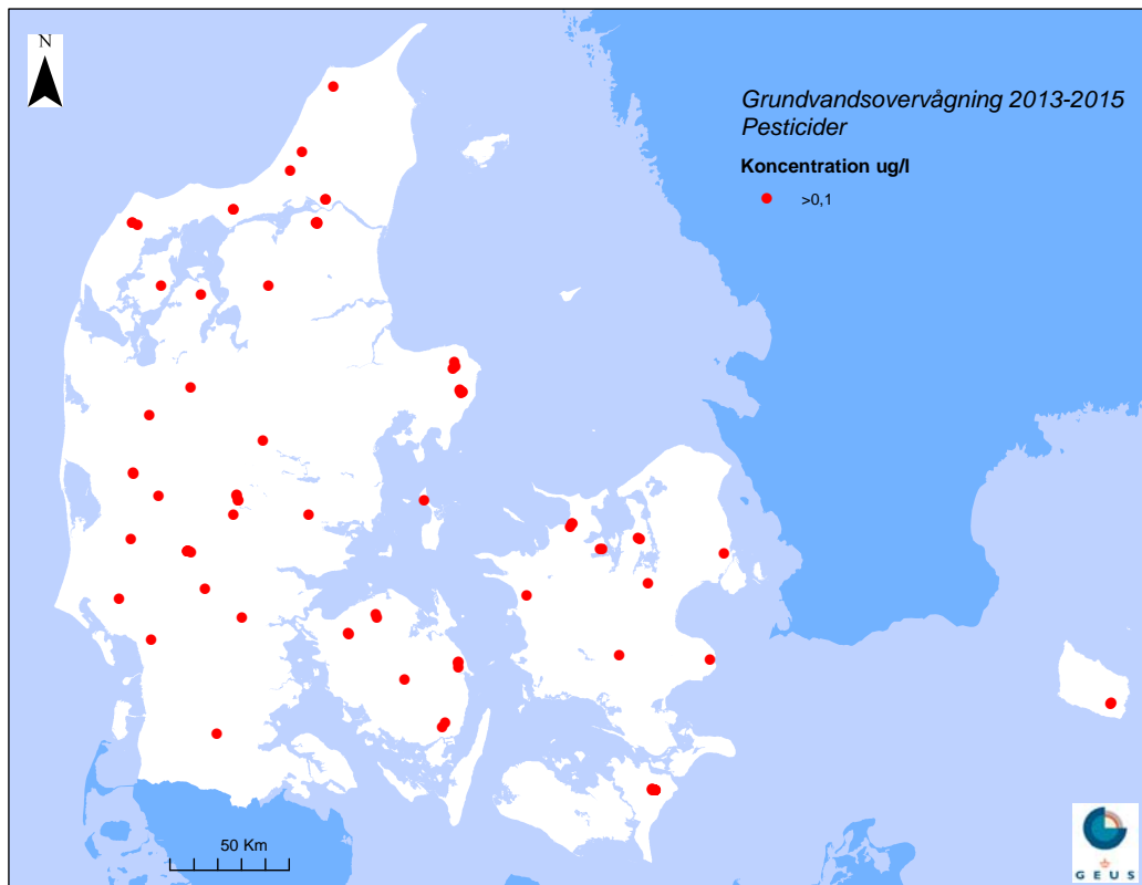
Figur 12.3 GRUMO. Pesticider og nedbrydningsprodukter i grundvandsovervågningen i perioden 2013-2015. Kun indtag hvor et pesticid er påvist mindst én gang over kravværdien (>0,1 µg/l).
