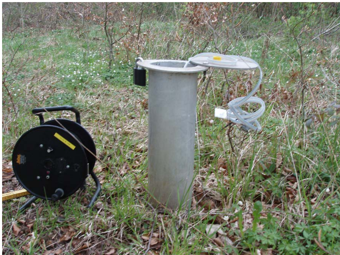
Figur 2 Håndpejl og tommestok ved boring. Bemærk hvorledes håndpejlet med gul "dymo-mærkning" er identificerbar.
