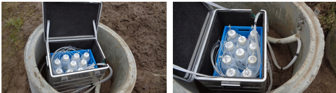
Figur 2-1. Termoboks med 10 stk. 2L prøvetagningsflasker og optagelig indre kasse
